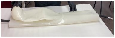
5. Bevor Sie das Dichtungsband an der Blase anbringen, stellen Sie sicher, dass sie mittig auf dem Kopf des Installationswerkzeugs sitzt.
