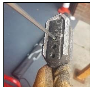
Zurückschneiden beschädigter Welle
