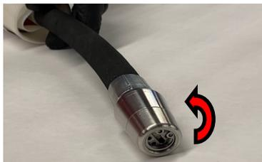
Drehen Sie den Dampfanschluss mit einem Standard-Schlitzschraubendreher gegen den Uhrzeigersinn, bis er vollständig geöffnet ist, um den Dampffluss während des Aushärtens zu ermöglichen.
