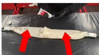
4. Tragen Sie Picote Blasentrennmittel auf und verteilen Sie es gleichmäßig auf dem Hauptkörperbereich, wo die Anschlussmanschette platziert werden soll. Dies verbessert den Halt der Manschette während der Installation und erleichtert die Entnahme nach dem Aushärten. Verfärbungen der Blase durch Harz können so ebenfalls verhindert werden.
