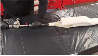
10. Beaufschlagen Sie die Blase mit einer geringen Menge Luft (0,1bar, um den Hauptkörper der Blase aufzublasen.
