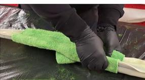
16. Vakuumieren Sie die Blase vollständig, während Sie die gesamte Baugruppe so fest wie möglich zusammenfalten.
