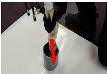
**Aushärtung bei Umgebungstemperatur:** Stellen Sie mit einem Standard-Schlitzschraubendreher sicher, dass der Dampfanschluss vollständig geschlossen ist, indem Sie ihn im Uhrzeigersinn drehen, bis er vollständig geschlossen ist.
