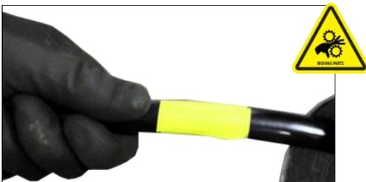
Wenn Sie keine Opferwelle verwenden, bringen Sie eine optische Markierung (Klebeband) an der Ummantelung der flexiblen Welle an. Platzieren Sie sie etwa 500mm vor dem Ende der Welle.
