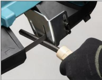
Überprüfen Sie die Welle vor jedem Gebrauch. Lassen Sie die Maschine kurz im Uhrzeigersinn laufen, damit die Welle in ihre Ruheposition zurückkehrt. Bei möglichen Schwachstellen oder Beschädigung der Welle, kürzen Sie sie um die die beschädigte Länge mit einer Bandsäge. Bei den meisten Werkzeugen sollte die Welle ~40 mm über das Gehäuse hinausragen. Hubs und Original Kettenschleudern ohne Opferwelle erfordern eine weiter herausragende Welle.
