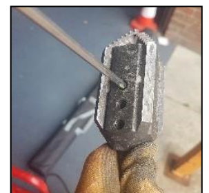
Zurückschneiden beschädigter Welle
