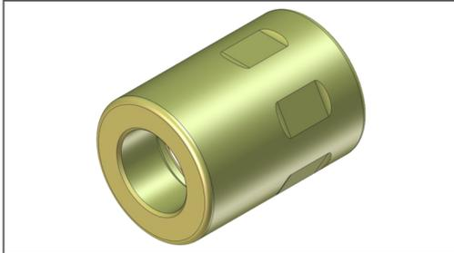
Verwenden Sie bei der Arbeit mit dem Midi Cleaner stets eine Endkappe. Das verlängert die Lebensdauer der flexiblen Welle und verhindert das Verschmelzen der Wellenummantelung mit dem Werkzeugende. Endkappen können wiederverwendet werden, wenn die Ummantelung gekürzt wird.
