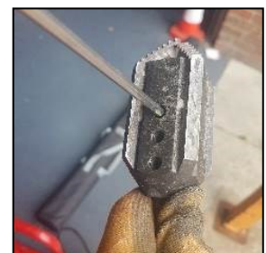
Zurückschneiden beschädigter Welle
