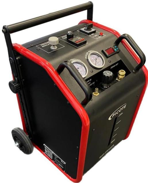
Leistungsstarke Dampf-aushärtung für Anschlussmanschetten, Punkt-reparaturen und CIPP Liner
