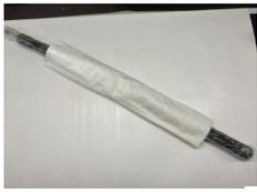
7. Schneiden Sie die erforderliche Menge Liner/Patch ab, um sicherzustellen, dass die Größe der Reparatur innerhalb des Abschnitts zwischen den Off-Limits-Zonen bleibt.
