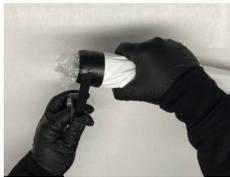
B). Falten Sie den Stützschauch sorgfältig um die Endkappe. Befestigen Sie den Stützschauch in seiner Position, indem Sie es an den Endkappen festkleben. Decken Sie die Gewindeanschlüsse an den Endkappen **nicht** ab.
