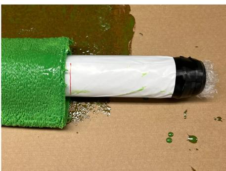
Verwenden Sie die zuvor markierten Linien und stellen Sie sicher, dass der Patch zentriert ist und nicht in die Sperrzonen hineinragt.
