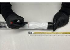
C). Kopieren Sie die Messung der Off-Limits-Zone und markieren Sie sie mit einem Markierstift auf der Oberfläche des Stützschauchs.
