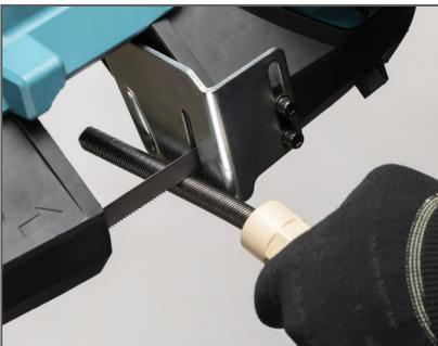
Überprüfen Sie die flexible Welle vor jedem Gebrauch. Bei möglichen Schwachstellen oder Beschädigung der Welle kürzen Sie die Welle um die beschädigte Länge mit einer Bandsäge.
