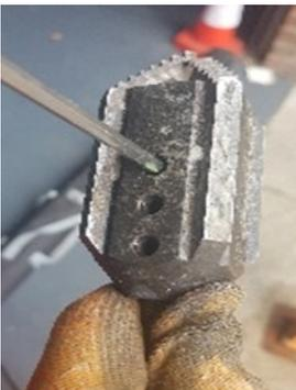
Achten Sie darauf, die Schrauben stets festzuziehen, wenn Sie ein Werkzeug montieren, beginnend mit der Schraube, die am weitesten vom Ende der flexiblen Welle entfernt ist (sofern zutreffend).
