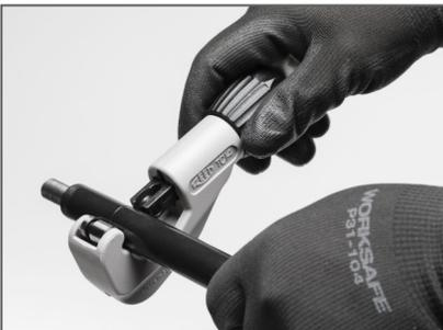
Überprüfen Sie die Wellenummantelung vor jedem Gebrauch. Der einfachste und sicherste Weg, die Ummantelung auf die richtige Länge zu kürzen, ist die Verwendung eines Wellenschneiders.
