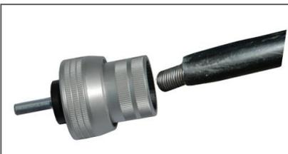
Der Wellenglätter wird verwendet, um das Ende der flexiblen Welle zu glätten und zu verhindern, dass sich der Anwender an der scharfen Metallkante schneidet.
