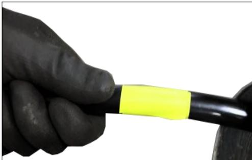
Wenn Sie keine Opferwelle verwenden, bringen Sie eine optische Markierung (Klebeband) an der Ummantelung der flexiblen Welle an. Platzieren Sie sie etwa 500mm vor dem Ende der Welle.
