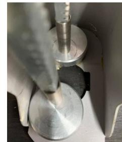
4. **Stellen Sie sicher, dass der Smart Mixer 2 große Stößel installiert hat.** Um den Stößel zu ersetzen, entfernen Sie den Bolzen im Kopf und wechseln Sie zum größeren Stößel.
