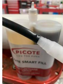
2. Schieben Sie den Förderschlauch der Mini Coating Pumpe über die Spitze des Statikmischers.
